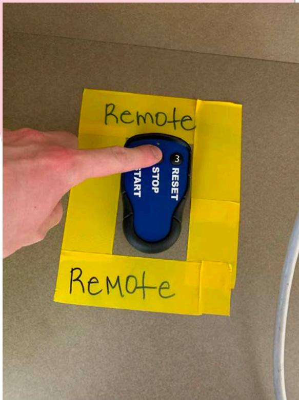
Figura 15 –Detén el ciclo utilizando el control remoto en cuanto se llegue a la dosis mínima de irradiación necesaria.
