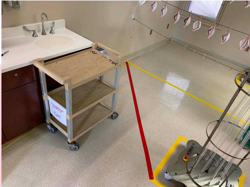
Figura 10 –No bloques el arco de luz del UVGI hacia los respiradores.
